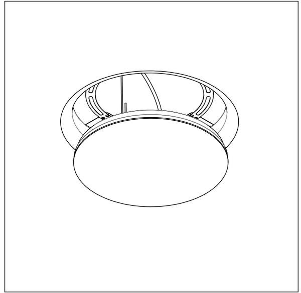
Установите световой модуль в корпус светильника
