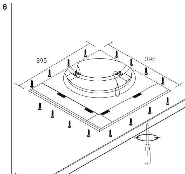
Сделайте отверстие в листе гипсокартона, соответствующее размерам выбранной модели светильника 855x855 мм. Прикрепите лист гипсокартона к металлическим направляющим с помощью саморезов.
