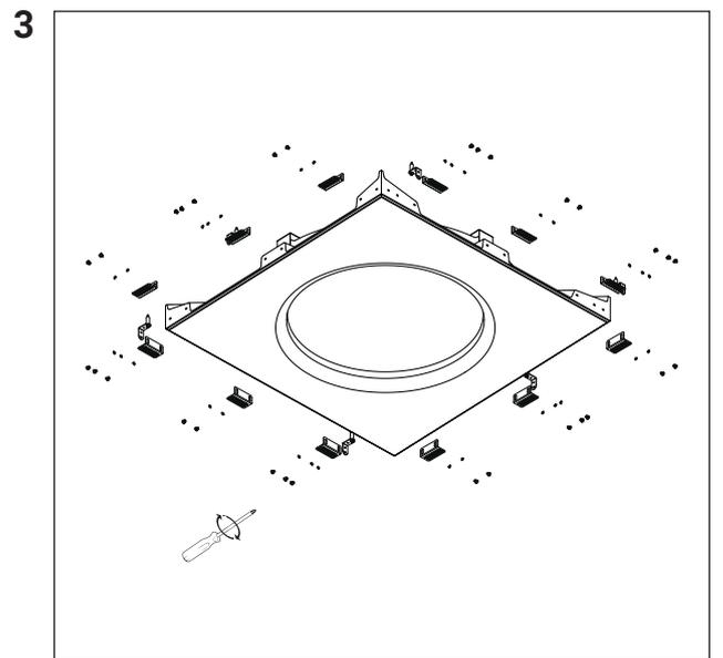
Закрепите на корпусе крепежные элементы (поз. 4) с помощью винтов (поз. 5) и шайб (поз. 7), идущих в комплекте.
