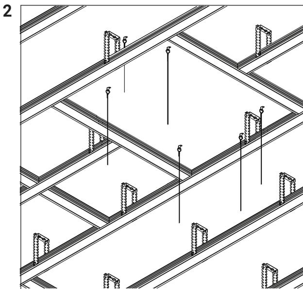
Закрепите тросовые подвесы для корпуса светильника (поз. 8) к основному потолку.
