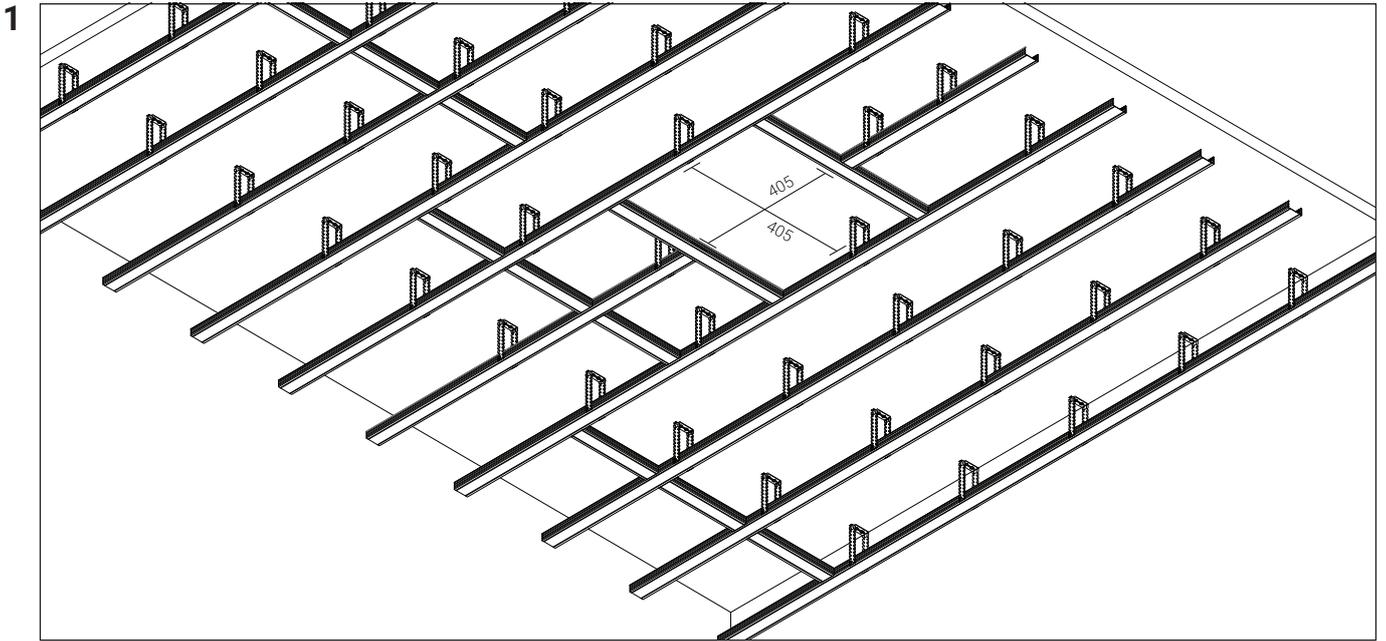
При установке металлоконструкции потолка осуществите монтаж каркаса для крепления гипсового корпуса светильника: предусмотрите расстояние между направляющими 865x865 мм.
