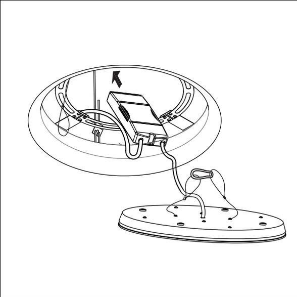
Подключите световой модуль (поз. 2) к блоку питания (поз. 3).
