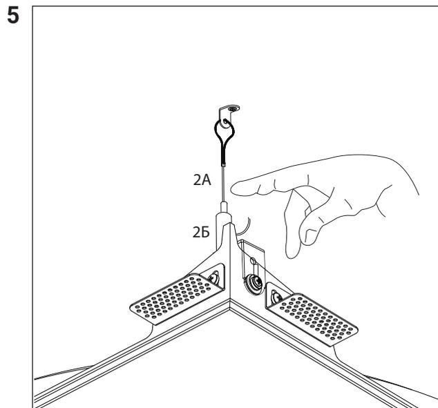
Проденьте тросик (поз. 2А) в цангу (поз. 2Б). Отрегулируйте длину тросика нажатием на верхний элемент цанги.
