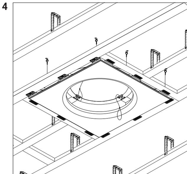
Закрепите гипсовый корпус (поз. 1) на направляющих при помощи саморезов-клопов (поз. 6). Закрепите крепления тросовых подвесов (поз. 8) между собой - см. шаг №5.
